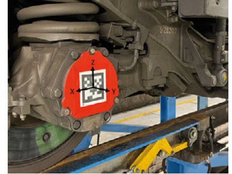
6: Ein QR-Code ist mit einem magnetischen Halter am Radlagergehäuse eines Drehgestells befestigt. Das vom QR-Code definierte Koordinatensystem ist exemplarisch dargestellt
