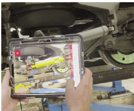
1: Einblendung von virtuellen Objekten und Zusatzinformationen am Beispiel der Demontage eines Drehdämpfers an einem Drehgestell
