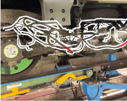
4: Darstellung der Konturen eines Kabelbaums innerhalb eines Drehgestells
