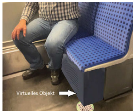
2: Bauraumuntersuchung am Beispiel einer Verkleidung eines Untersitzcontainers. Dabei können der Freiraum für die Füße und der optische Gesamteindruck gut bewertet werden
