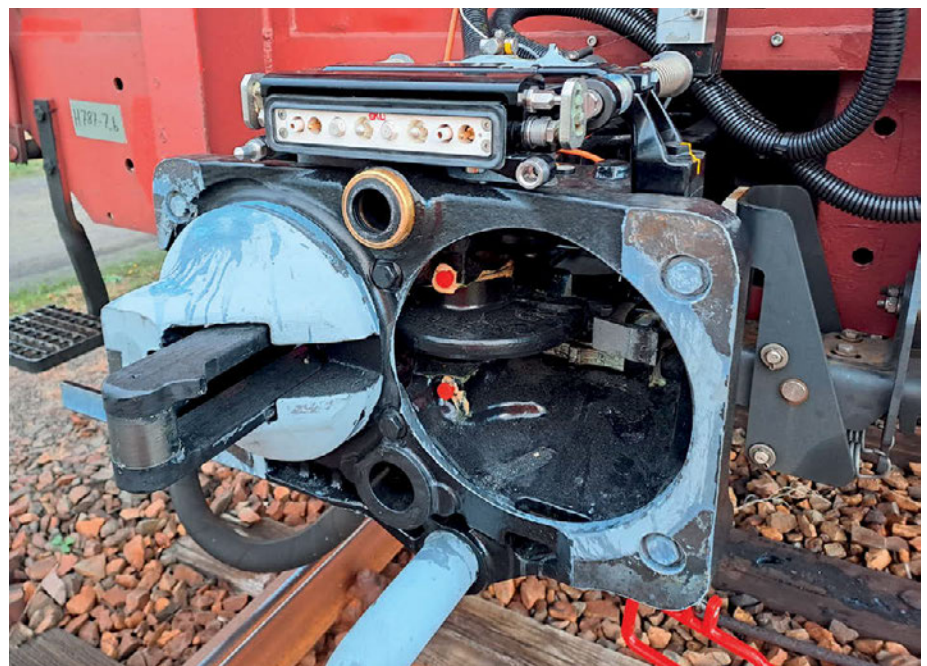
Abb. 1: Neues E-Kupplungsdesign während der Erprobung im Herbst 2023 mit geöffneter Klappe im gekuppelten Zustand der DAK
