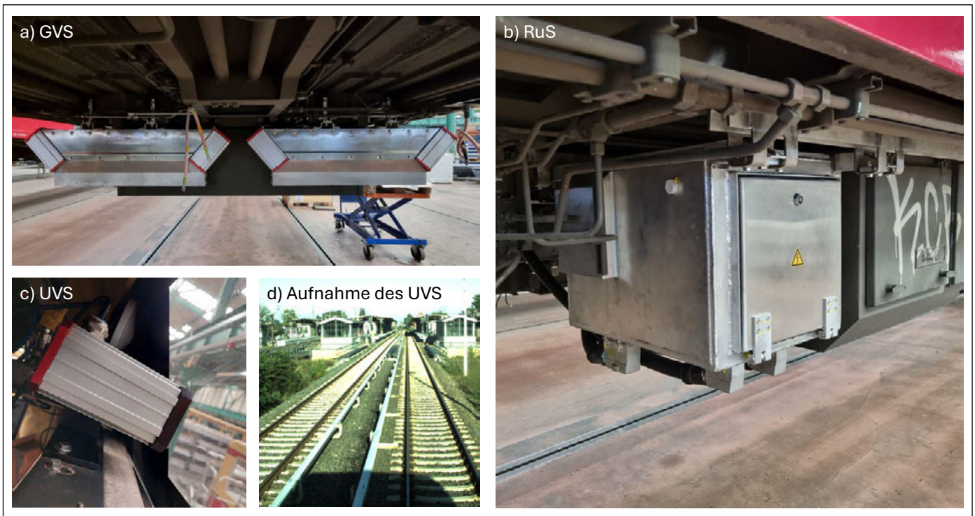
Abb. 3: Fotoaufnahme des CTM-VM: a) Gleisvideosystem (GVS); b) Rechen- und Speichersystem (RuS); c) Umfildvideosystem (UVS); d) Aufnahme des Umfildvideosystems (Foto beschnitten)
