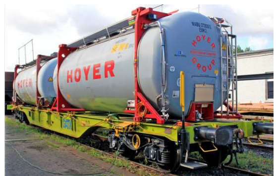
3: Links: Versuchsfahrzeug mit einem 45-Fuß-Tankcontainer für Auflaufstoßversuche und Fahrversuche durch einen engen S-Bogen. Rechts: Versuchsfahrzeug mit zwei 26-Fuß-Tankcontainern mit und ohne Schwallwände für Auflaufstoßversuche
