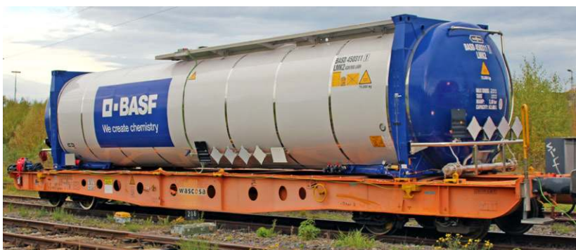
3: Links: Versuchsfahrzeug mit einem 45-Fuß-Tankcontainer für Auflaufstoßversuche und Fahrversuche durch einen engen S-Bogen. Rechts: Versuchsfahrzeug mit zwei 26-Fuß-Tankcontainern mit und ohne Schwallwände für Auflaufstoßversuche
