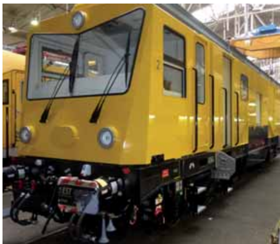
3-teiliger Fräszug HSM Firma Gleisbaumechanik Brandenburg (GBM)
