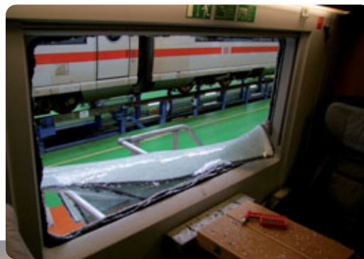
Abbildungen: Durchschlag des Scheibenpakets nach Funktionsprüfung
