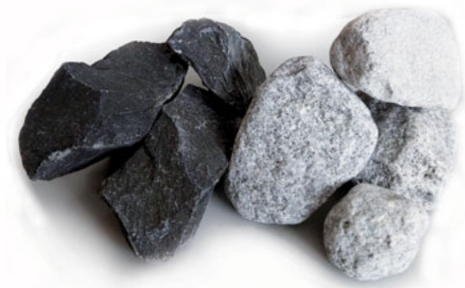
Abbildung 1: Gleisschotter vor und nach einer LA-Prüfung
